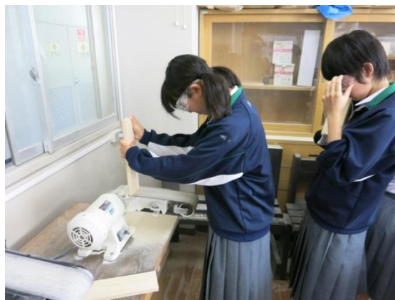
図 6-8 2段ラック製作の様子 ベルトグラインダによる部品加工
