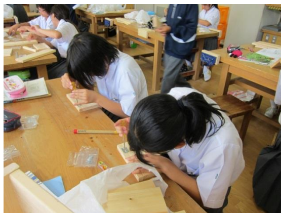
図 6-10 2段ラック製作の様子 蝶番の取り付け
